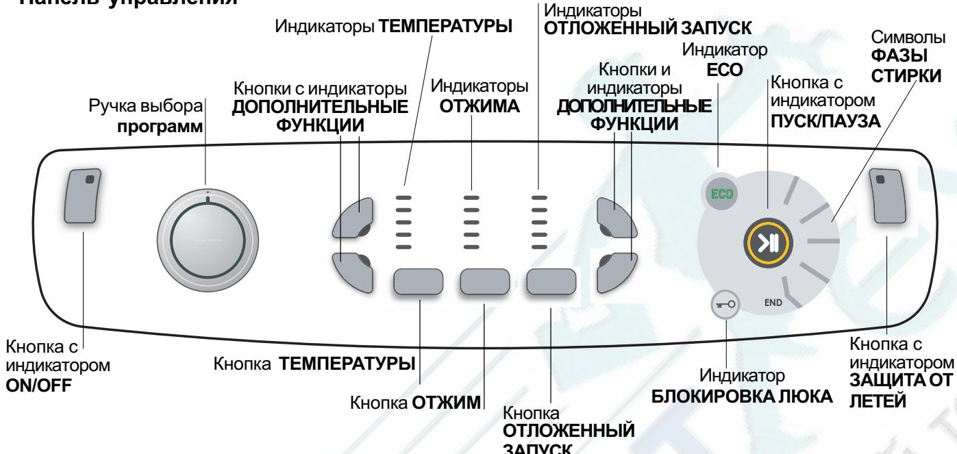
**Кнопка с индикатором ON/OFF:** нажмите кнопку один раз для включения или выключения машины. Зеленый индикатор показывает, что машина включена. Для выключения стиральной машины в процессе стирки необходимо держать нажатой кнопку, примерно 3 секунды. Короткое или случайное нажатие не приведет к отключению машины.
