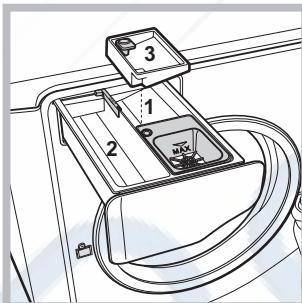
Эта функция служит для удаления наиболее трудных пятен. Может использоваться как с отбелителем, так и без него. Если требуется произвести также отбеливание, вставьте дополнительный прилагающийся дозатор 3 в ячейку 1.
